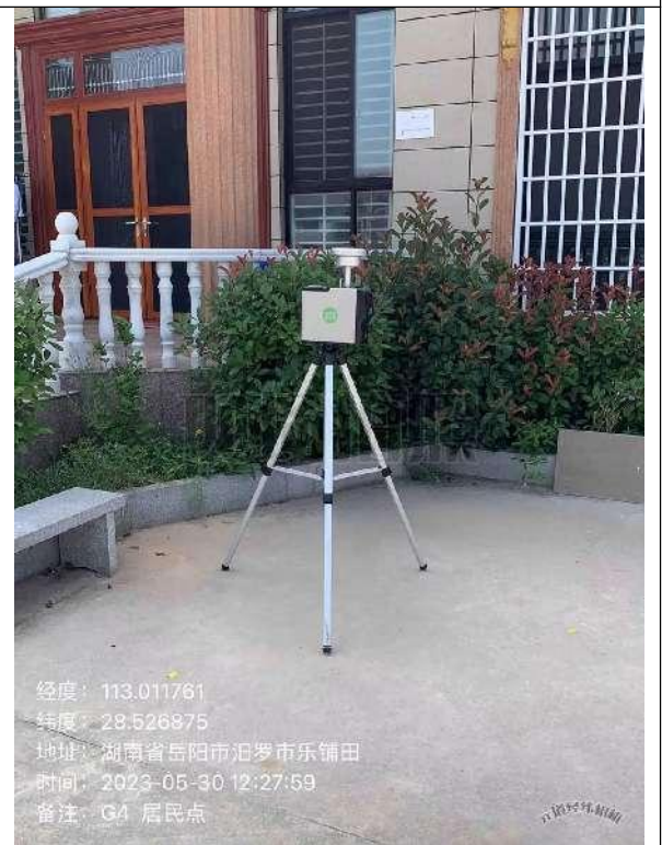
无组织废气采样照片 4
